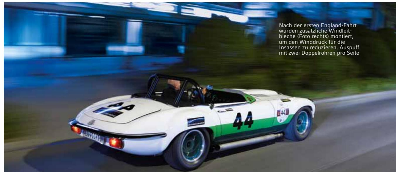
Nach der ersten England-Fahrt wurden zusätzliche Windleitbleche (Foto rechts) montiert, um den Winddruck für die Insassen zu reduzieren. Auspuff mit zwei Doppelrohren pro Seite
